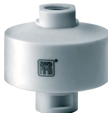
Realizzati per isolare l'elemento sensibile di manometri, pressostati e trasmettitori elettronici di pressione da fluidi di processo corrosivi, viscosi e sedimentosi. Una membrana elastica serrata meccanicamente e sottoposta a prova di tenuta garantisce la separazione del fluido di trasmissione da quello di processo. L'assenza di viti e bulloni di assemblaggio ne previene ogni tipo di corrosione. Trova impiego in impianti galvanici, trattamento acque, irrigazione, produzione schede elettroniche
